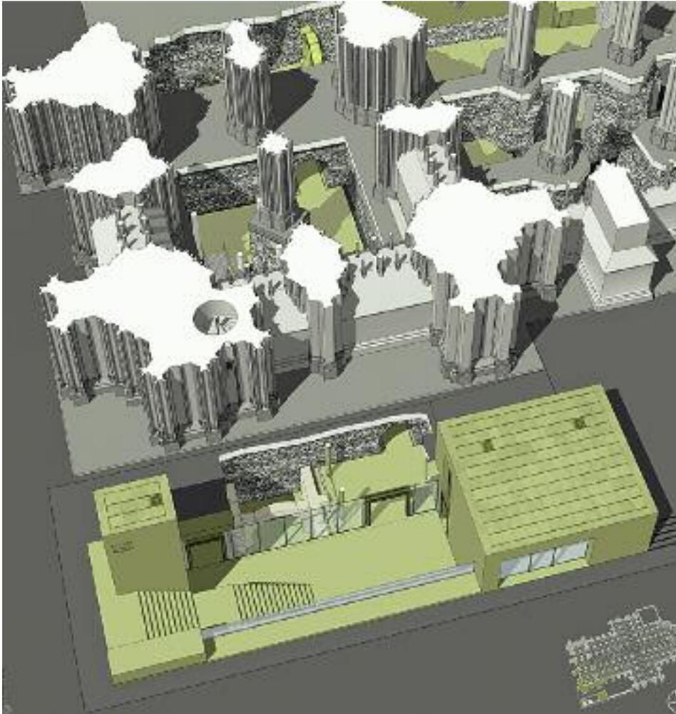
34. Südturmfundament und neues Eingangsgebäude zur Turmbesteigung, Isometrie.
