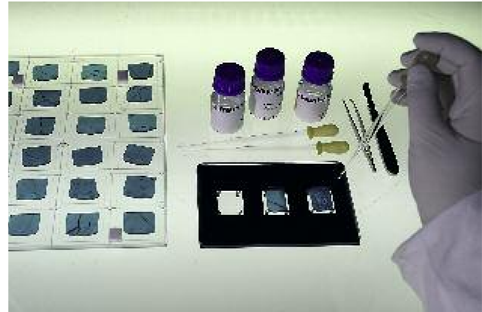
18. Tränkungsversuche an craquelierten Testgläsern mit dem Festigungsmaterial A 18.
