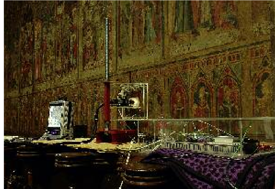
24. An den Chorschranken eingesetzte Mikroklimatekammer zur Untersuchung von »Formänderungen der Malerei« durch Zusatz und Entzug von Feuchtigkeit.
