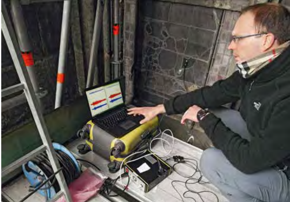
27. Vibrationsmessungen am Christusfenster.
