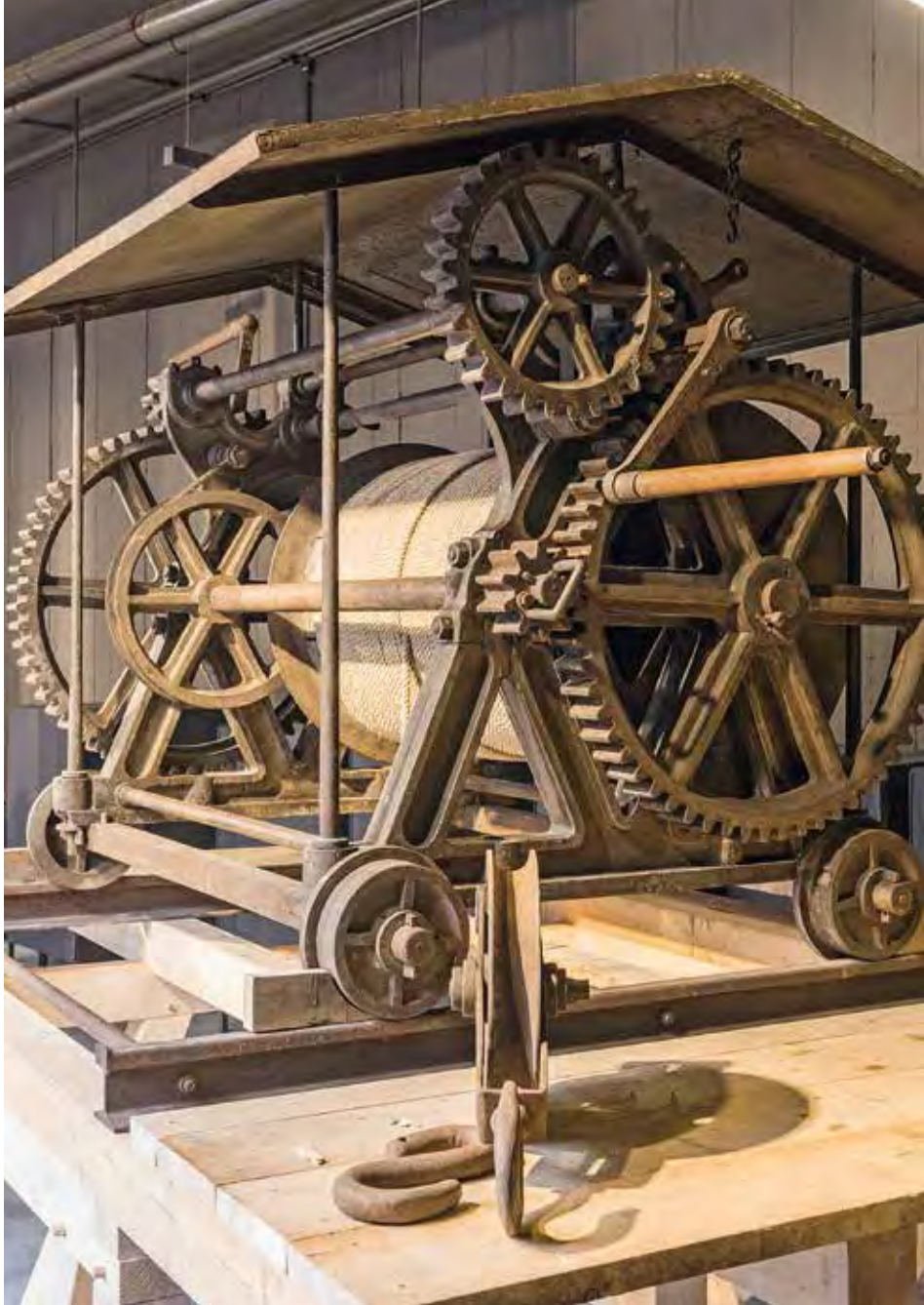
19. Im Schaudapot der Dombauhütte wiederaufgebaute historische Seilwinde des 19. Jahrhunderts.
