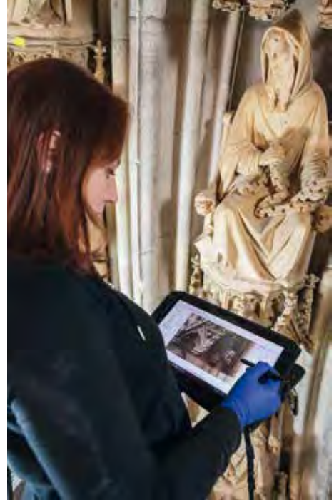
5. Kartierung eines Konsolbaldachins am Michaelportal mithilfe eines Tablets.
