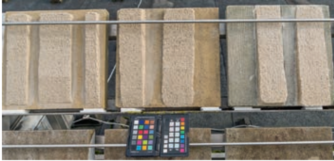
4. Untersuchungen zu Modellierbarkeit, Haftung und kapillarer Wasseraufnahme an Steinersatzmassen für Schlaitdorfer Sandstein
