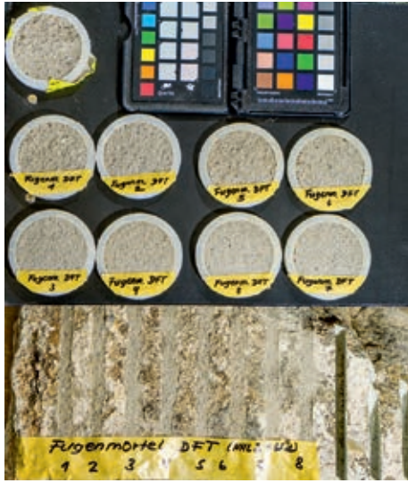
10. Versuche an acht verschiedenen Fugenmörteln für die Restaurierung des mittelalterlichen Trachytmauerwerks des Chorkapellenkranzes
