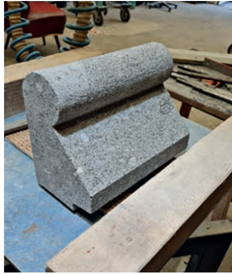
11. Vierung aus Peperino Duro für die Restaurierung des mittelalterlichen Trachytmauerwerks des Chorkapellenkranzes
